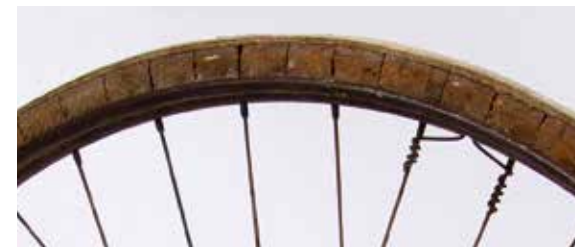
Deel van een fietswiel met houten band Metaal, hout, leer, afm.: 70 x 3 cm Collectie: Flipje en Streekmuseum Tiel (nr. 01700)
